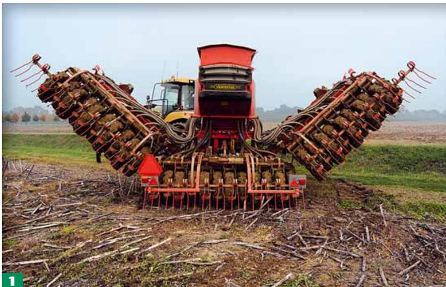
**1.** L'operatrice durante il trasporto su strada rientra in sagoma (larghezza 3 metri) grazie al **ripiegamento dei due moduli del telaio**, con un'altezza di 4 metri
