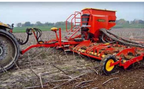
Il sistema di gestione prevede la **possibilità di utilizzare solamente metà operatrice** o di escludere le file in corrispondenza delle corsie di traffico
