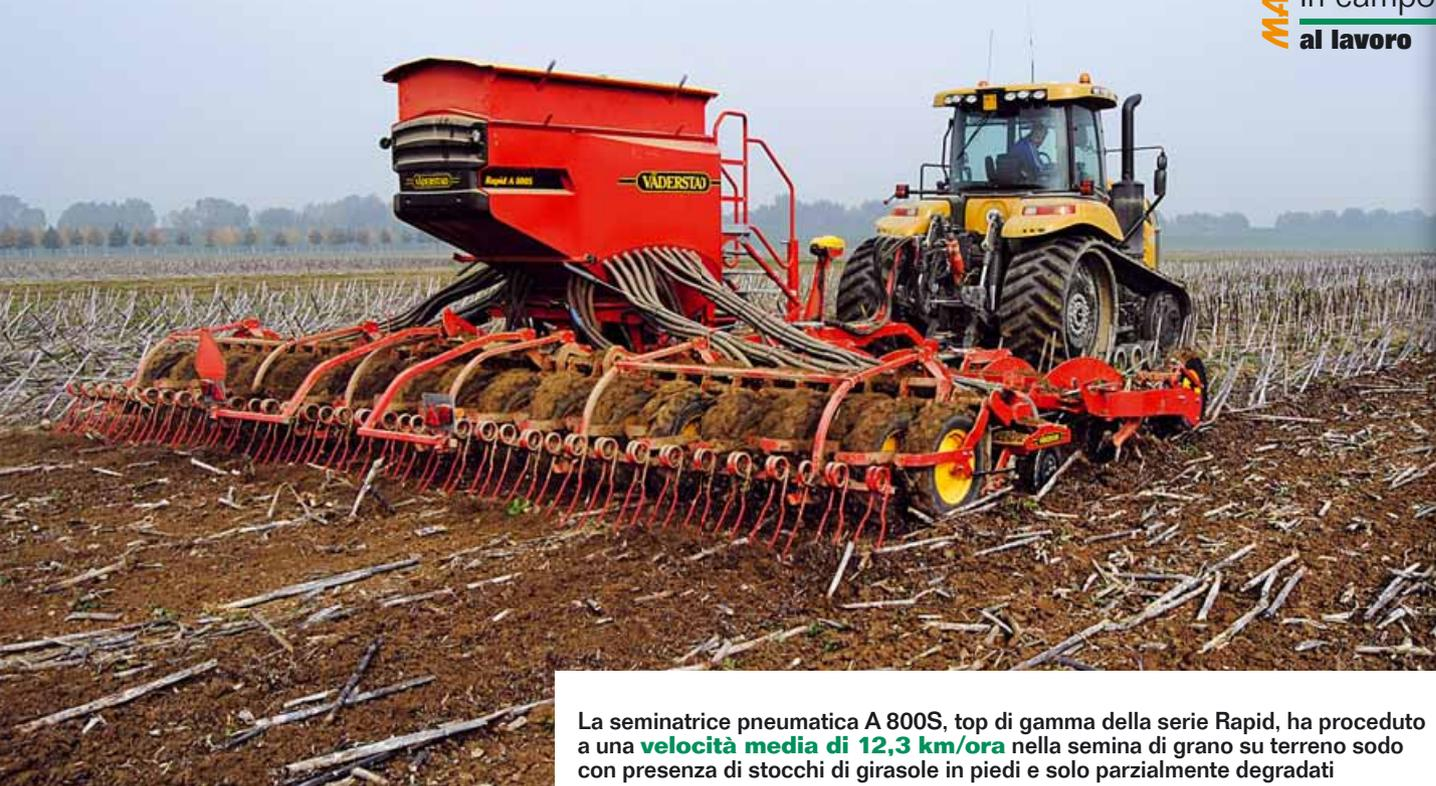
La seminatrice pneumatica A 800S, top di gamma della serie Rapid, ha proceduto a una **velocità media di 12,3 km/ora** nella semina di grano su terreno sodo con presenza di stocchi di girasole in piedi e solo parzialmente degradati
